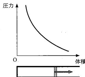
図4 気体の断熱変化
